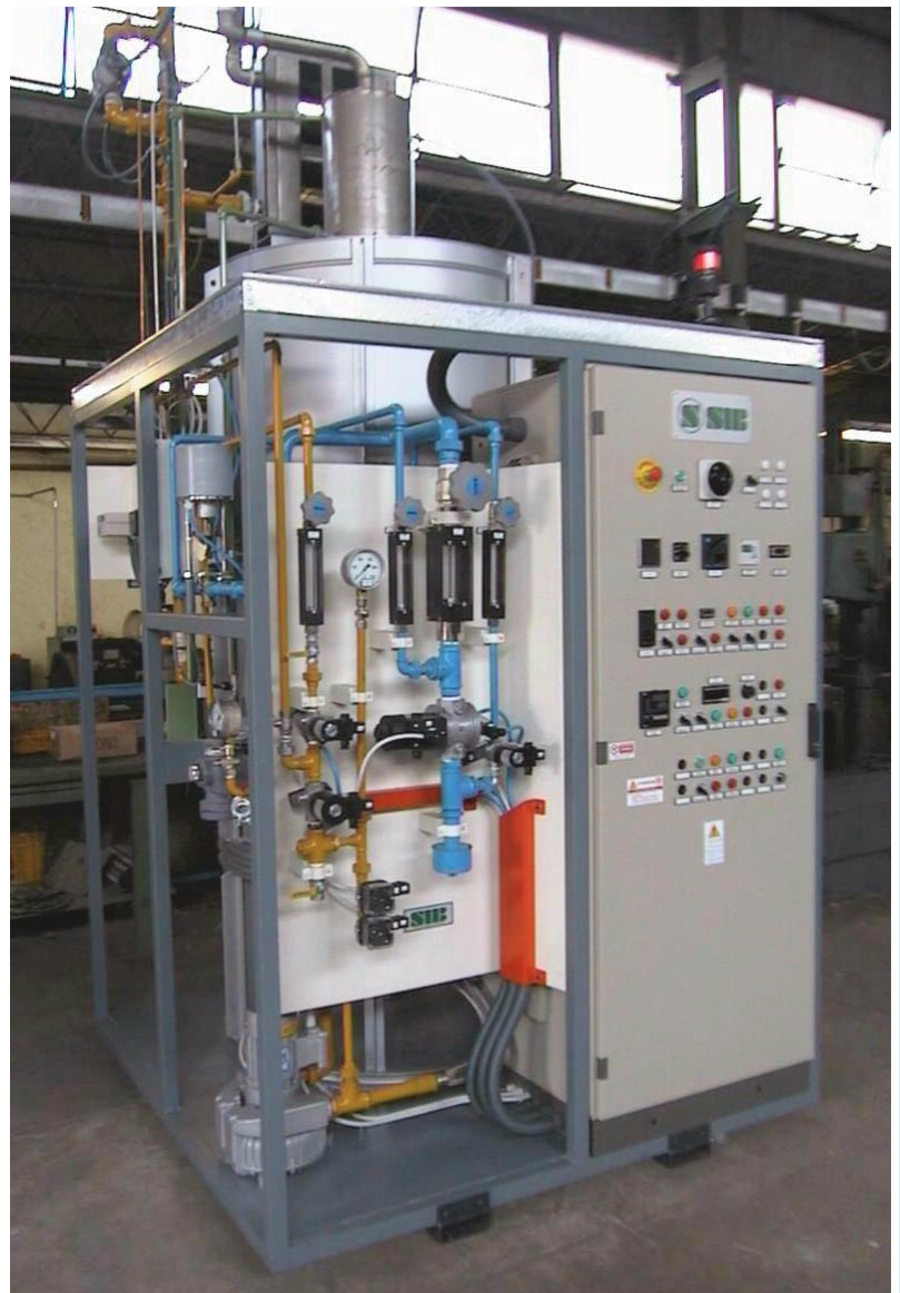
Generatore mod. 444 con regolazione automatica del punto di rugiada Gas generator mod. 444 with Dew Point automatic regulation ( \lambda probe) Endogasgenerator Modell 444 mit Automatischregelung von Taupunkt
